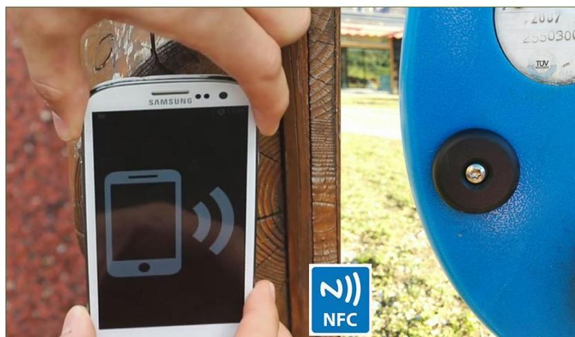
Fig. 9: Registrazione delle ispezioni sui giochi tramite Tag NFC.
