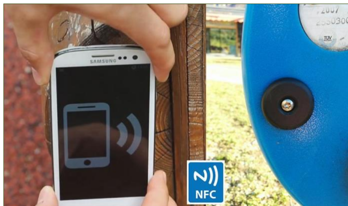
Fig. 7: Registrazione delle ispezioni sui giochi tramite Tag NFC.
